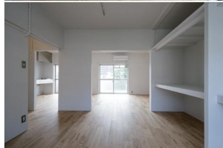
新たな都市生活者の層にターゲットを絞り、1~3 階は、無垢フローリング、白塗装、ミニマルなステンレスキッチンによるシンプルな内装にリノベーションしている。4 階は、設備改修のみで供給し、自由に DIY できる住戸としている。
